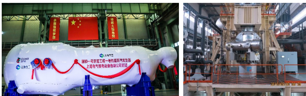
图 6-1 “国和一号”蒸汽发生器、屏蔽电机主泵
